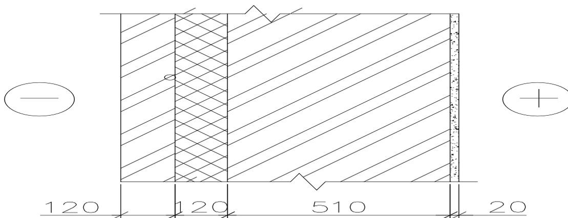
Рис. 1. Расчетная схема стены с наружным утеплением.
