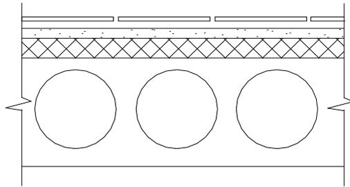
Рис. 3. Расчетная схема перекрытия над подвалом.
