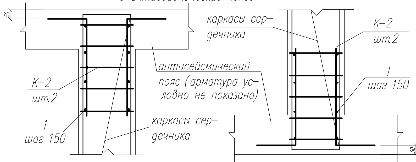
Детали заделки монолитных сердечников в антисейсмические пояса
